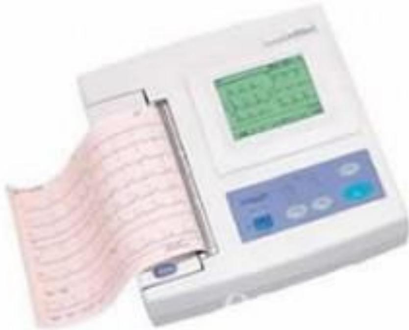
倒联：十二道同步采集及记录、标准 12 导联
